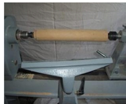
Vue du montage entre pointes, image : www.tournage-sur-bois.info
