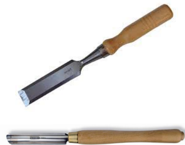
Le ciseau à bois se distingue de la gouge par son bout profilé et plein et non creux
