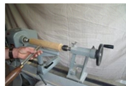
Position de l'outil pendant le cylindrage, image : www.tournage-sur-bois.info
